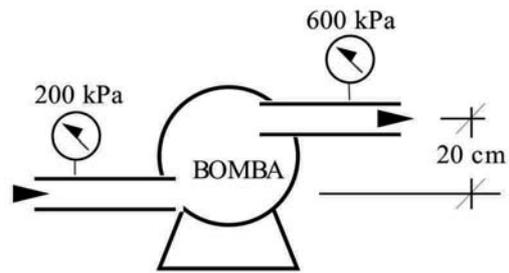
A bomba é usada para aumentar a pressão de  $0,2 \text{ m}^3/\text{s}$  de água de 200 kPa para 600 kPa. Se a bomba tem uma eficiência de 85%, qual a potência elétrica de que a bomba necessita?
