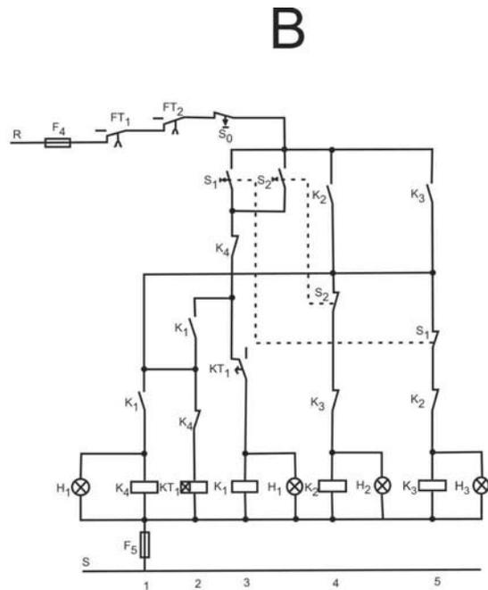
37) Analisando os diagramas das figuras A e B que trazem, respectivamente, um diagrama de força e um de comando, é correto afirmar que ambos são de partida de motor
