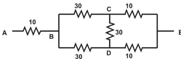
Assinale a alternativa que indica corretamente o valor da resistência equivalente entre os pontos A e E.
