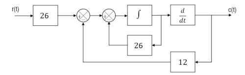
A função de transferência  $\frac{C(s)}{R(s)}$  do sistema representado por esse diagrama é dada por:
