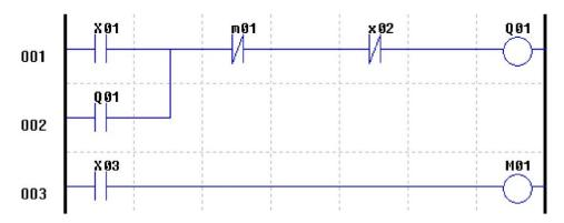
Sabendo que x02 representa uma chave que ativa o desligamento de emergência da carga conectada na saída Q01 e interpretando o programa ilustrado acima, pode-se afirmar que a bobina virtual é utilizada nesse caso para:
