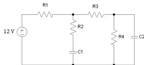
Dado que o circuito já se encontra em regime permanente, com  $C_1$  e  $C_2$  completamente carregados, a soma da energia armazenada nos capacitores é igual a
