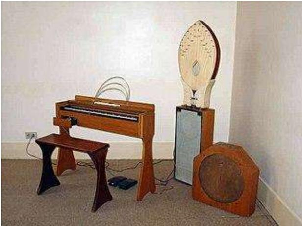
caracteriza-se como um instrumento de teclados que produz um som ondulante com válvulas eletrônicas de frequência oscilatória. A intenção do educador musical era criar um instrumento versátil, que fosse, de certa forma, familiar aos instrumentos de orquestra. Com o decorrer da sua utilização, o instrumento foi sendo aprimorado e tornou-se característico pelos seus efeitos de delay e pelas frequências de oscilação produzidas pelas válvulas.
