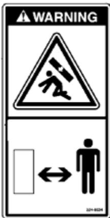
a) CUIDADO - Existe um perigo de esmagamento quando se abaixa a lança ou quando cai uma carga. Afaste-se da lança quando a máquina estiver em operação. Caso não se fique longe da lança, isso poderá causar ferimentos ou morte.
