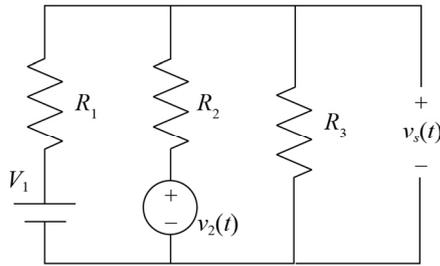
Considerando que, no circuito representado na figura precedente,  $R_1 = 1 \text{ k}\Omega$ ,  $R_2 = 4 \text{ k}\Omega$ ,  $R_3 = 4 \text{ k}\Omega$ ,  $V_1 = 3 \text{ V}$  e  $v_2(t) = 6 \cdot \text{sen}(140\pi t) \text{ V}$ , julgue os próximos itens.
