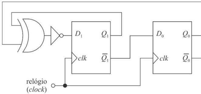
A figura precedente representa um circuito sequencial com 2 bits, que utiliza *flip-flops* do tipo D, gatilhados por borda de subida. A sequência é iniciada por ação de um circuito de *reset* não explicitado na figura, a partir do estado  $D_1D_0 = 00$ .
