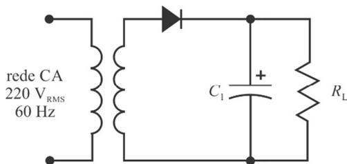
O circuito representado na figura precedente, que corresponde a uma fonte não regulada simples, é constituído por um transformador que reduz, na proporção de 18:1, a tensão no primário do transformador, que é de  $220 V_{RMS}/60 \text{ Hz}$ ; por um diodo retificador; e por um capacitor  $C_1$  de  $2.000 \mu\text{F}$ , sendo a carga um resistor  $R_L$  de  $200 \Omega$ .
