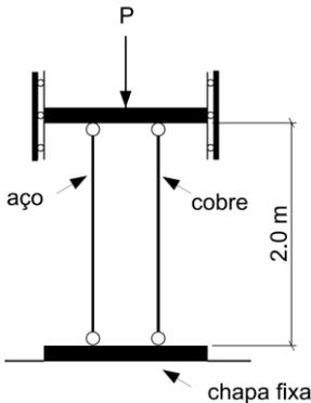
Sobre a chapa superior, é aplicada uma carga **P** que a desloca verticalmente. Sabe-se, ainda, que as barras possuem seção transversal quadrada de lado 6cm e que os módulos de Young do aço e do cobre valem, respectivamente, 200GPa e 100GPa.
