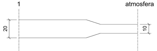
Desprezando as perdas de carga ao longo da tubulação e assumindo  $\pi = 3$ , aceleração da gravidade igual a 10m/s² e peso específico da água de 1000kgf/m³, a pressão da água na seção 1 é de
