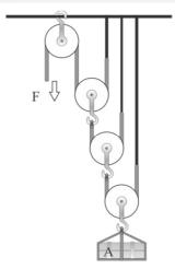
Se, no sistema de polias precedente, o corpo A pesar 8.000 kgf, então a força F, em módulo, necessária para manter o corpo A suspenso será de
