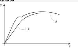
Com base no resultado dos testes de tração em corpos de prova para os materiais A e B mostrado no diagrama tensão *versus* deformação precedente, assinale a opção que apresenta, respectivamente, as relações corretas entre A e B para os parâmetros resiliência (R), ductibilidades (D) e tenacidades (T).
