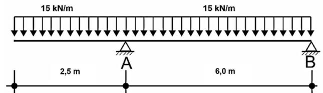
A viga está submetida a uma carga uniformemente distribuída igual a  $p = 15 \text{ kN/m}$ . Analisando os esforços submetidos ao sistema, verifica-se que
