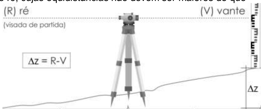
Figura 6 Diagrama de nivelamento geométrico. Fonte: USP (Universidade de São Paulo); Escola Politécnica. Nivelamento geométrico. São Paulo: EPUSP, 2013. Disponível em: < https://edisciplinas.usp.br/pluginfile.php/212165/mod_resource/content/1/aula%2009%20PTR2201 >. Acesso em: 10 ago. 2024.
