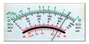
A figura acima retrata o visor de um instrumento de medidas elétricas ajustado para medição de corrente elétrica, cuja leitura registrada é:
