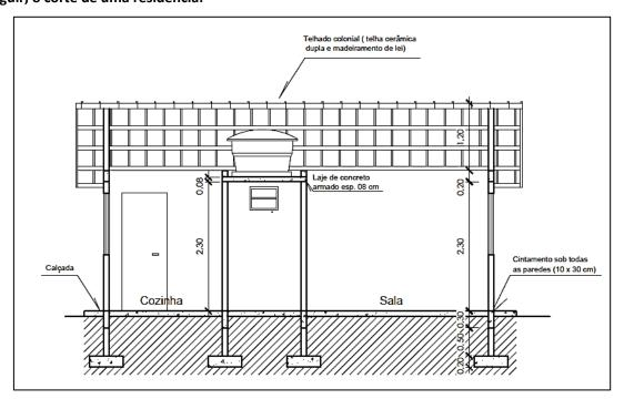
Sabendo que as sapatas são quadradas com lado de 0,70 metro, calcule o volume de concreto, em metros cúbicos, para o total das quatro sapatas mostradas no corte, conforme a figura.
