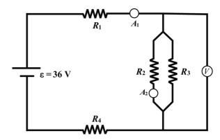
No circuito elétrico mostrado na figura precedente, o gerador, o voltímetro V e os amperímetros  $A_1$  e  $A_2$  são ideais. Considerando que os resistores  $R_1$ ,  $R_2$ ,  $R_3$  e  $R_4$  tenham resistências elétricas respectivamente iguais a 3  $\Omega$ , 6  $\Omega$ , 12  $\Omega$  e 5  $\Omega$ , julgue os próximos itens.
