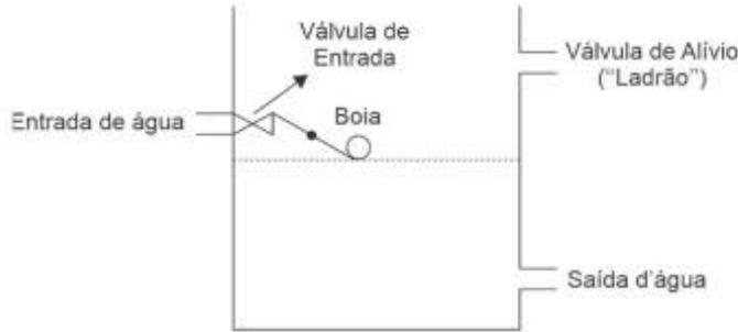
Uma caixa d'água de um sistema predial com boia é um sistema de armazenamento de água simples e eficiente, usado para garantir o abastecimento regular em residências e reserva técnica para incêndio. O funcionamento básico pode ser descrito em etapas:
