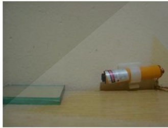
(a) Montagem experimental do espelho de Lloyd.
