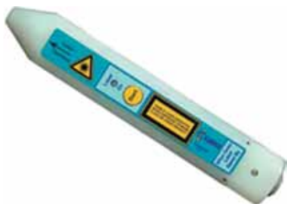
Laser de infravermelho emite radiação a uma onda de 800 nm.
