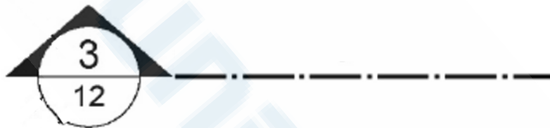
Figura 2 – Simbologia da indicação de corte
