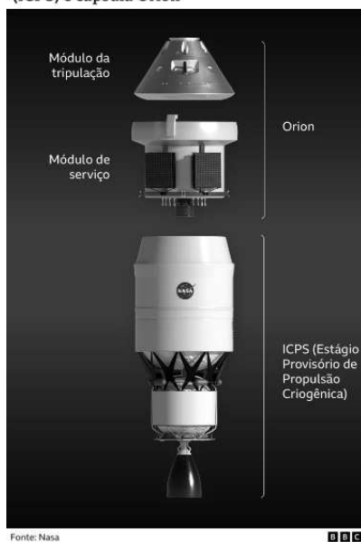
Estágio Provisório de Propulsão Criogênica (ICPS) e cápsula Orion
