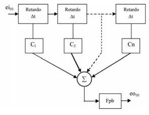
No circuito, C1, C2,..., Cn, são ganhos de tensão nos sinais das saídas dos retardos,  $\sum$  é um somador e Fpb é um filtro passa-baixas. Sendo a entrada  $e_{i(t)}$  um pulso e com a saída  $e_{o(t)}$ , o circuito é usado como um:
