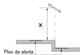
a) Barra de apoio inclinada
