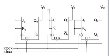
O circuito ilustrado na figura apresenta uma máquina de estados, onde  ${\rm Q}_2$  representa o bit mais significativo e 1 o nível lógico alto. O estado inicial é  ${\rm (0)}_{10}$ , obtido pela ativação do sinal de *clear*. Os próximos três estados desta máquina, representados na base 10, são:
