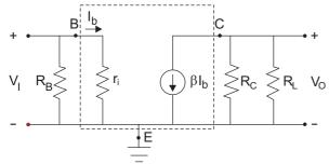
Dados:  $\beta$ =100;  $R_c$ =3 $k\Omega$ ;  $R_i$ =2 $k\Omega$ ;  $R_g$ =10 $k\Omega$ ;  $r_i$ =1 $k\Omega$ A figura mostra o circuito correspondente ao modelo para sinais de um estágio transistorizado. De acordo com os valores fornecidos para os componentes, o ganho de tensão
