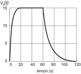
No circuito apresentado, a chave S tem sua posição alternada entre os contatos 1 e 2 a cada minuto. Através de medidas realizadas, foi possível elaborar o gráfico da tensão  $V_0(t)$ . As resistências de  $\rm R_1$  e  $\rm R_2$ , em  $\rm k\Omega$ , que mais se aproximam do comportamento apresentado no gráfico, respectivamente, são:
