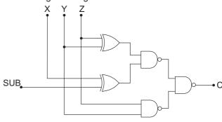
A figura mostra parte de um circuito digital somador/subtrator de 1 bit, onde X, Y, Z, SUB e C são variáveis booleanas que assumem níveis lógicos 0 e 1. A expressão simplificada para a saída C, quando SUB vale 1, é:
