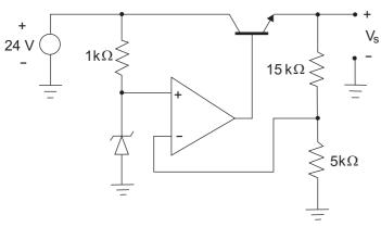
O circuito ilustrado corresponde a um conversor / regulador de tensão. Considerando que o amplificador operacional seja ideal e que o diodo Zener seja de 4 V, a tensão de saída V<sub>s</sub>, em volts, do regulador será:
