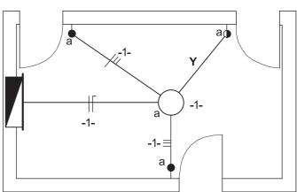
A figura acima mostra parte do diagrama unifilar do projeto elétrico de uma residência. O ponto de luz "a" é alimentado pelo circuito -1- e pode ser acionado de três interruptores diferentes, conforme indicado na figura.
