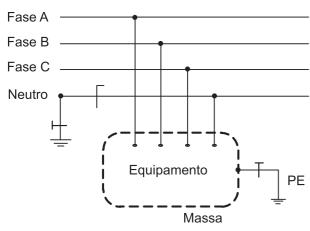
A figura acima mostra como um equipamento trifásico foi conectado à rede que alimenta uma determinada instalação elétrica em baixa tensão.
