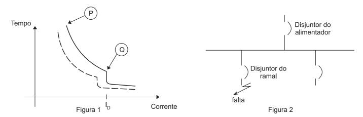
A figura 1 representa as curvas de atuação de dois disjuntores termomagnéticos, sendo um em linha tracejada, e outro, em linha cheia. A figura 2 ilustra um circuito de alimentação radial protegido por disjuntores, onde ocorre um defeito no circuito a jusante do disjuntor do ramal.
