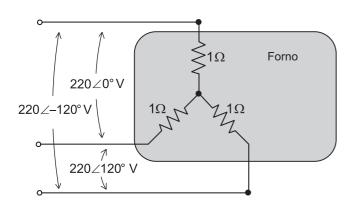
A fonte de calor de um forno elétrico industrial é proveniente de um banco trifásico de resistores de 1  $\Omega$  por fase, conforme indicado na figura acima. O forno opera oito horas por dia e é conectado à rede elétrica, cujo valor rms da tensão de linha é 220 V.
