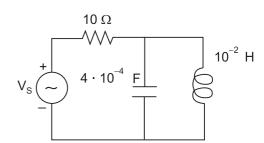
Considere os parâmetros elétricos do circuito RLC mostrado na figura acima, onde  $\rm V_S$  é uma fonte de tensão senoidal.
