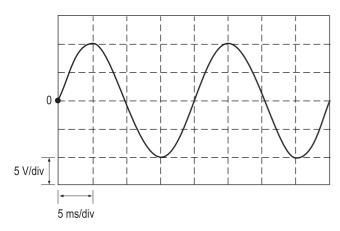
A figura acima mostra o oscilograma da forma de onda da tensão em um determinado nó de um circuito elétrico. Considerando como origem de tempo o ponto 0, indicado na figura, essa forma de onda pode ser descrita em função do tempo, t, por uma função y(t), do tipo y(t) =  $V_m$  sen(2  $\pi$  f t) volts, em que  $V_m$  é dado em volts, e, f, em hertz.
