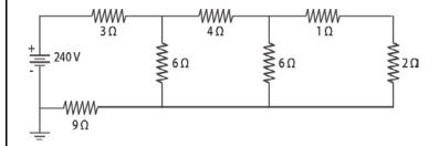
A tensão entre os terminais do resistor de 2  $\Omega$  vale:
