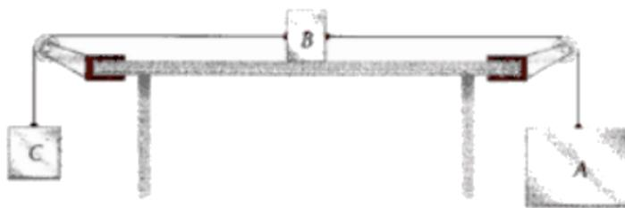
No arranjo experimental da figura, os corpos A, B e C têm respectivamente, massas iguais a  $m_A = 5kg$ ,  $m_B = 2kg$  e  $m_C = 3kg$ . A aceleração da gravidade é  $10m/s^2$ . Os fios são inextensíveis e de inércia desprezível; não há atrito entre os fios e as polias; o plano horizontal é perfeitamente liso. Determine a aceleração do sistemas dos corpos;
