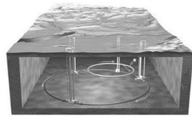
O diagrama acima mostra o tubo em forma de anel, onde um feixe de partículas elétricas (prótons ou íons) é acelerado por um campo elétrico e passa a rodar sob poderosos campos magnéticos (perpendiculares aos planos das órbitas dos feixes) em um sentido do anel, enquanto outro feixe acelerado roda no sentido oposto do mesmo anel. Até que, no momento certo, eles entram em rota de colisão, onde as forças elétricas e nucleares serão tão intensas que partículas poderão ser criadas.
