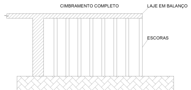
Figura 1 – Representação de uma laje em balanço.
