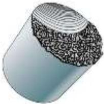
5. ( ) Ruptura por fadiga devido à flexão alternada com a ocorrência de desbalanceamento da amplitude da tração e compressão.
