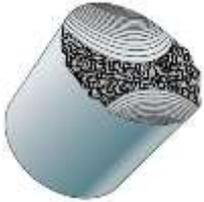
3. ( ) Ruptura por fadiga devido à torção alternada.
