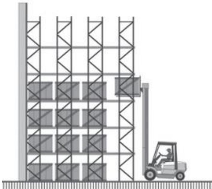
Este sistema é indicado para todos os tipos de cargas que são estocadas por longos períodos, sendo que o acesso é feito por um só extremo da estrutura; o outro extremo é fechado não permitindo qualquer acesso. O espaço para o trânsito interno é mínimo, requerendo habilidade do condutor.
