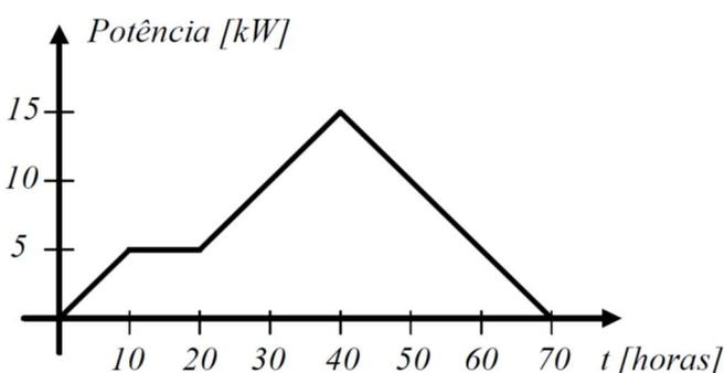
A figura representa a potência elétrica medida nos terminais de uma carga durante um período de 70 horas. A energia elétrica consumida pela carga durante esse período é igual a
