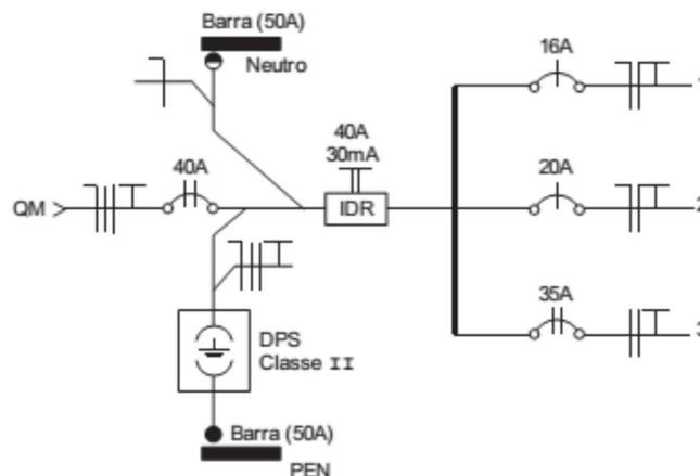
A figura ilustra o digrama unifilar de um quadro geral de baixa tensão em uma instalação elétrica. Quais são os tipos de proteção descritas no diagrama?
