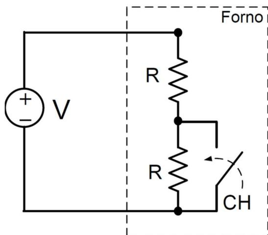
Os resistores no interior do retângulo tracejado representam um forno resistivo com uma chave seletora, CH. Quando a chave é fechada, um dos resistores com resistência de  $R$  ohms é curto-circuitado. A potência dissipada pelo forno após o fechamento da chave CH em relação à potência dissipada pelo forno com a chave CH aberta é
