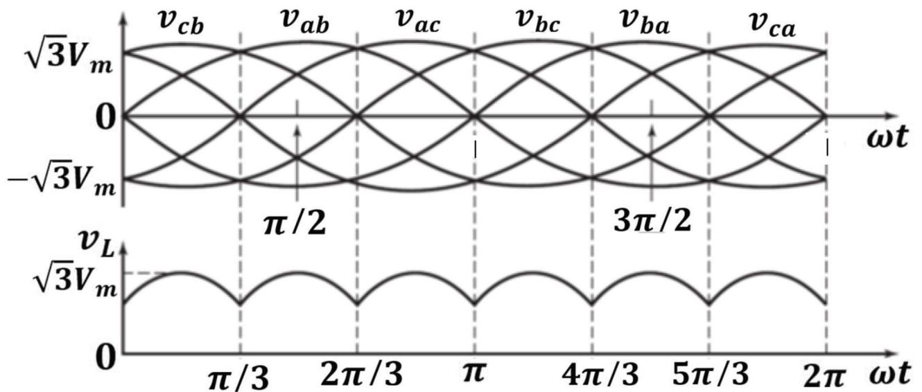
Na figura, estão representados dois gráficos correspondentes às formas-de-onda das tensões em um retificador a diodos. No gráfico superior estão as tensões em corrente alternada no retificador e no gráfico inferior está a tensão na saída do retificador em corrente contínua. Qual é o tipo de retificador correspondente às tensões representadas na figura?
