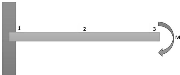
Considerando a figura precedente, que representa uma viga engastada em uma parede na região 1, sujeita apenas a um momento  $M$ , na extremidade 3, e desconsiderando o peso próprio da viga, julgue os itens subsequentes.
